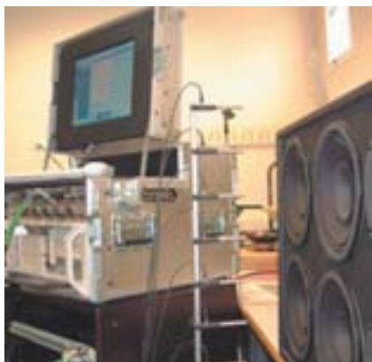
Sistema de caracterización de haces ultrasónicos focalizados: muestreo del haz mediante hidrófono y sistema de visualización del haz mediante la técnica de campo oscuro ("schlieren") con espejos parabólicos.
