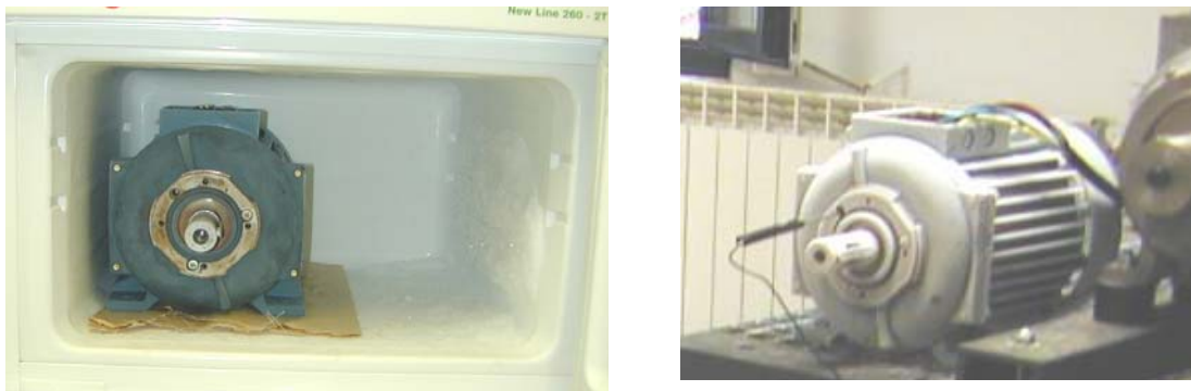
Figura 3. Cámara frigorífica utilizada para enfriar los motores (izqda), y sonda de temperatura para el control de la temperatura (drcha).
