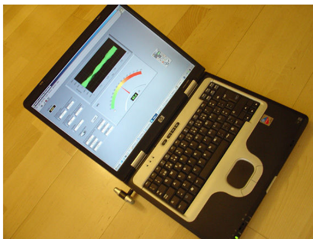
Figura 1 – Computador portátil com software de emulação de sonómetro medidor de SPL e microfone.
