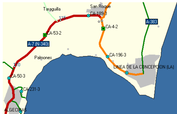
Figura 1 – En los recuadros azules están indicadas las estaciones de referencia en la Bahía de Algeciras. Fuente: Dirección General de Carreteras
