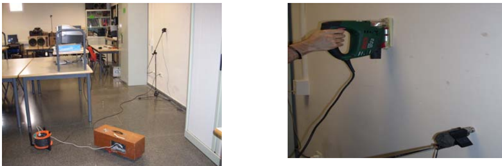
Figura 1- Mediciones forjado y medianera de la diferencia de velocidades en el laboratorio de acústica de la EPSG.
