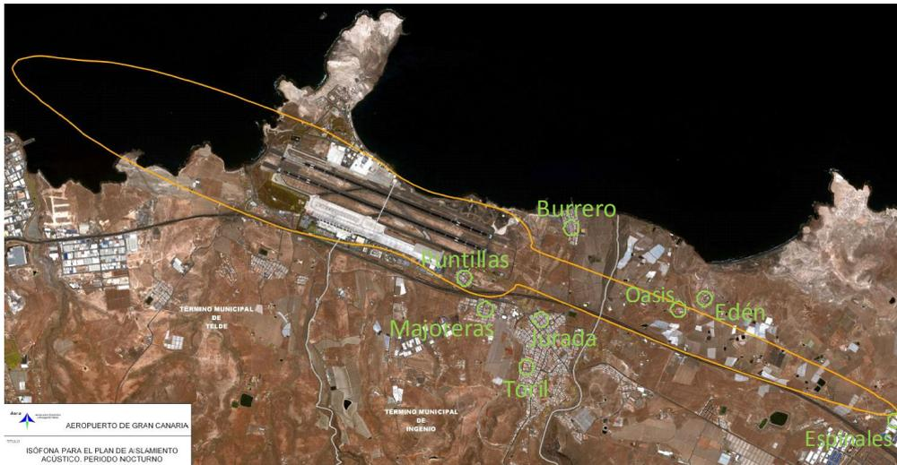
Figura 1 – Emplazamiento de las estaciones de medida vs. isófona de  $L_{AeqN}$  55 dBA.
