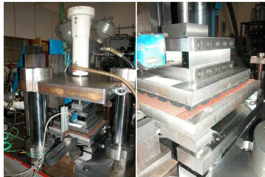
Figura 1: Banco de pruebas de dos componentes usado para caracterizar el comportamiento mecánico de las capas elásticas en dirección vertical y horizontal en la Dresden Technical University
