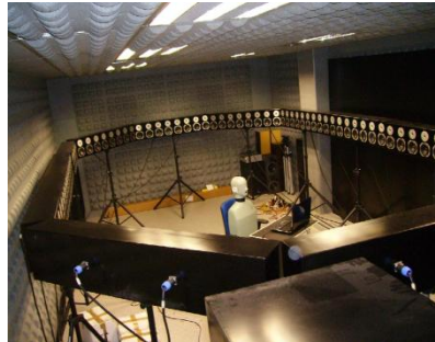
Fig 4. Sistema WFS compuesto por 96 altavoces del Instituto iteam en la UPV.
