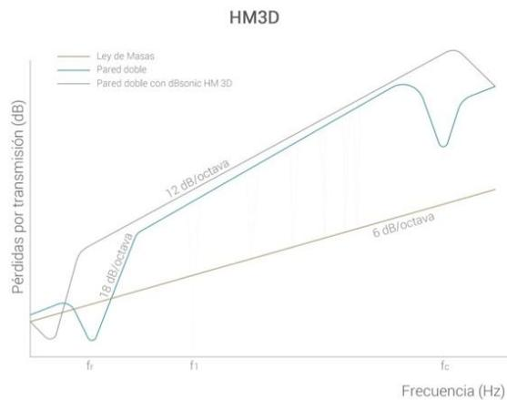
Para el caso del cartón yeso con bajo amortiguamiento interno, la masa pesada flexible aporta mayor amortiguamiento total en un sistema sándwich.
