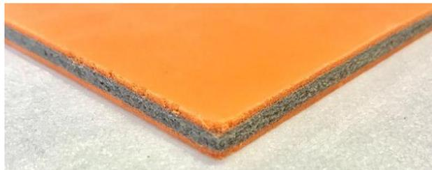
La configuración en tres capas también aumenta la resistencia que opone el medio de transmisión a las ondas que se propagan sobre este y por lo tanto es equivalente a la Impedancia (Z), es decir una forma de disipación de energía de las ondas que se desplazan en un medio. Se define como la razón entre la presión sonora (p) y la velocidad de las partículas (v) de un medio material.
