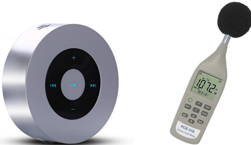
Figura 5. Imágenes del emisor inalámbrico y sonómetro empleados en los ensayos
