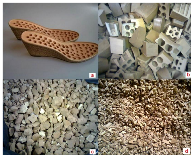
Figura 1 Material resultante das etapas de corte e moagem
