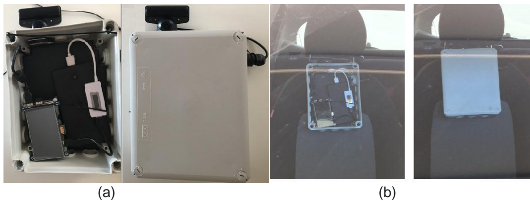
Figura 2. (a) Detalle del interior y exterior del dispositivo. (b) Instalación del dispositivo en interior del vehículo.
