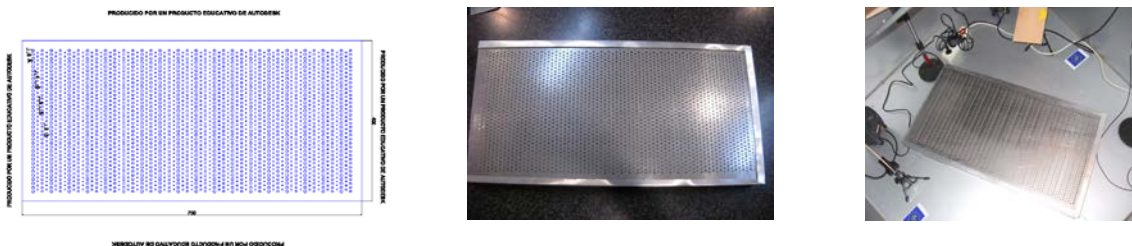
Figura 4. Diseño y prototipo de pantalla acústica con alguno de los nuevos perforados.
