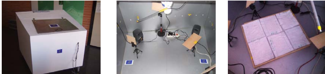
Figura 2. Imágenes de la cámara reverberante a escala y alguno de los ensayos realizados.
