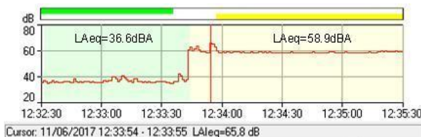
Figura 5. Cambio de nivel LeqA al poner en funcionamiento el motor de la incubadora. Micrófono localizado en el interior a la incubadora
