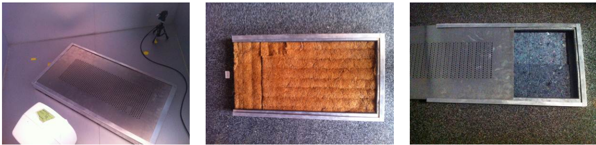
Figura 4 – Pantallas a escala elaboradas a partir de eco-materiales. Ensayos en cámara reverberante a escala.
