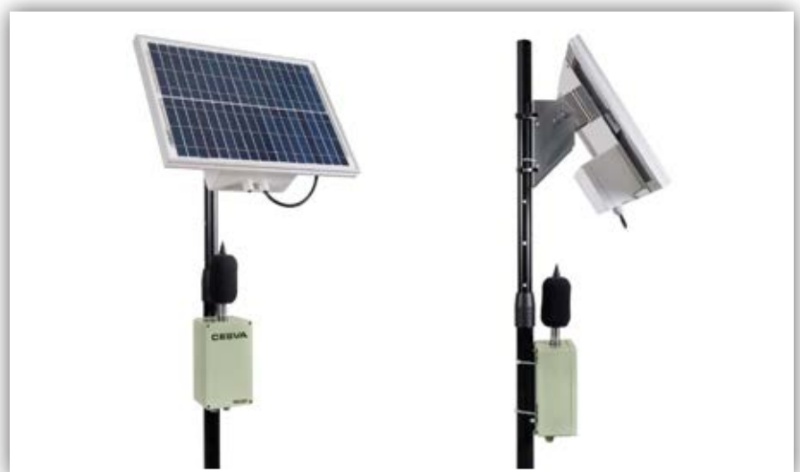
Solución PS120 de alimentación con Panel solar para el sensor TA120 de monitorización de ruido en smart cities
