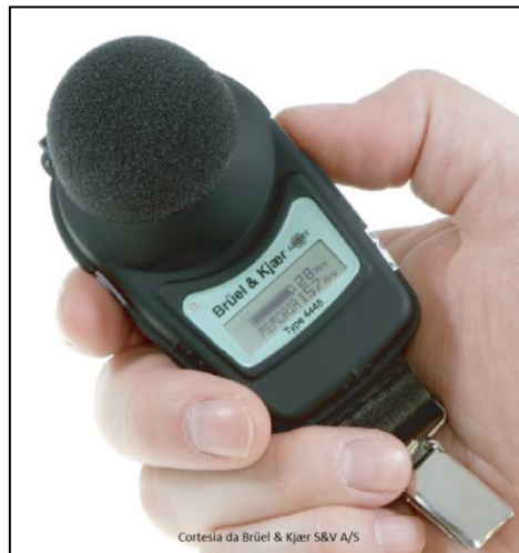
Figura 1 – Dosímetro de ruído tipo 4448 da Brüel & Kjær
