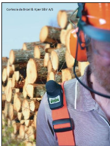
Figura 2 – Exemplo de montagem de um dosímetro de ruído num trabalhador
