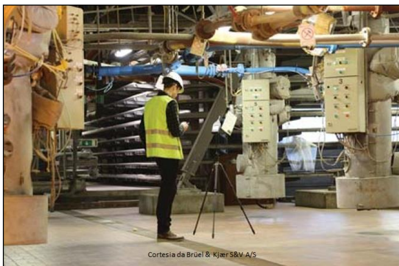
Figura 4 – Exemplo de avaliação de ruído ocupacional com recurso a sonómetro integrador
