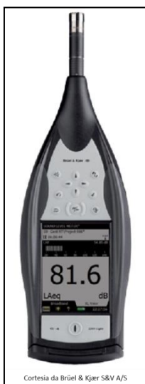
Figura 3 – Sonómetro integrador tipo 2250-L da Brüel & Kjær
