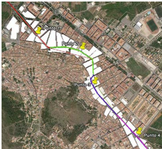
Figura. 3. Posiciones de micrófono establecidas para la toma de datos.
