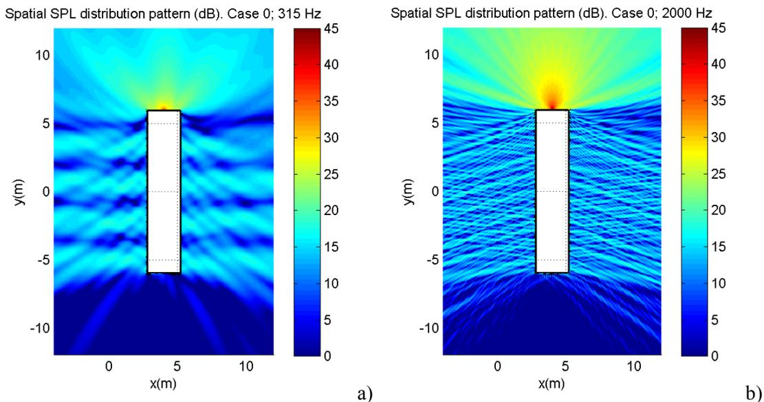
Figure 2 – Sound pressure field. a) Case 0, 315Hz; b) Case 0, 2000Hz.
