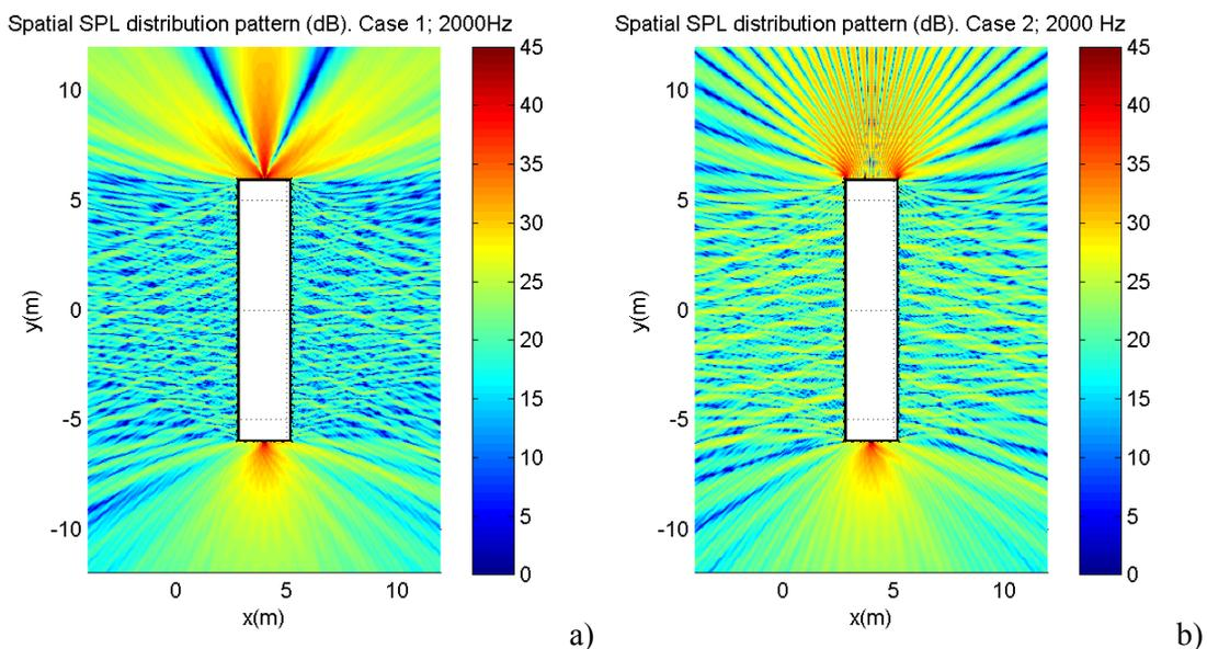
Figure 3 - Sound pressure field. a) Case 1, 2000Hz. b) Case 2, 2000Hz.
