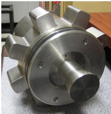
Figura. 4 Vista del montaje del transductor Langevin en la tapa del extractor de 5 L
