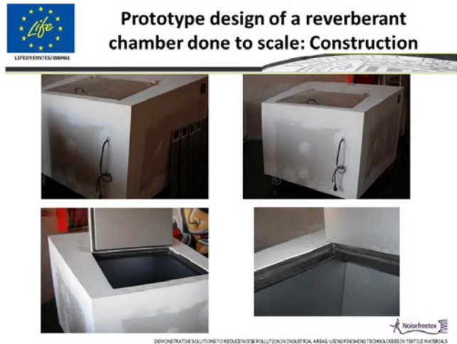
Figura 4. Cámara reverberante a escala (NOISEFREETEX)
