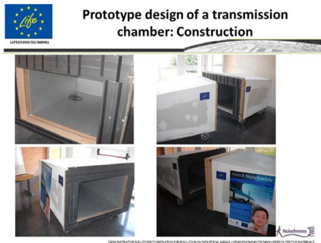
Figura 5. Cámara de transmisión a escala (NOISEFREETEX)
