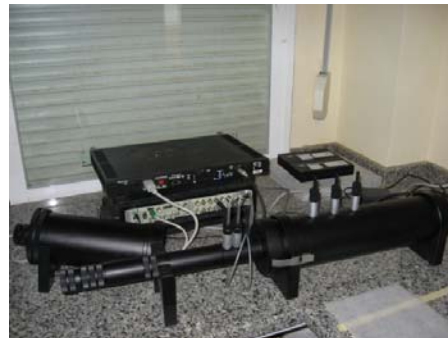
Fig. 11.- Detalle del tubo de impedancia
