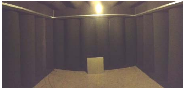
Figura 1 – Câmara semi-anecóica utilizada para medir coeficientes de difusão.
