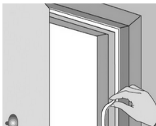
Figura 1 - Modo de aplicação do material isolante nas frinchas existentes no aro da porta.
