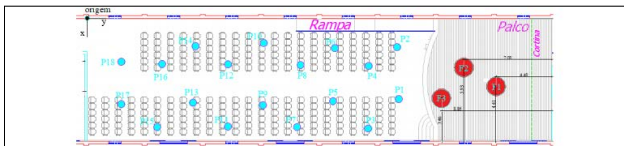
Figura 4 - Distribuição da posição dos pontos destinados a fonte Sonora (vermelho) e aos receptores (azul).
