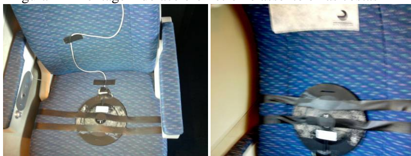
Figura 2 – montagem do acelerómetro no assento e nas costas
