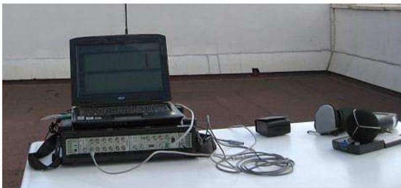
Figura 9 – Sistema PULSE de B&K
