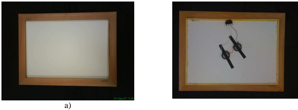
Figura 5. Altavoz DML utilizado en el trabajo tal como se comercializa: a) Parte delantera, b) Parte trasera donde se puede visualizar la posición de los actuadores.
