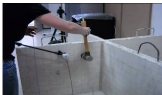
Figura 2. Detalle de la maqueta de hormigón durante la realización de medidas.
