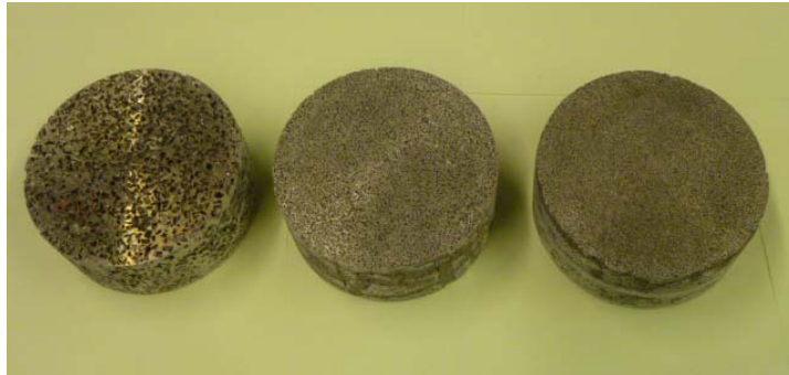
Figura 1. Fotografía de espumas de cada uno de los tres tipos de diámetro de poro fabricadas.
