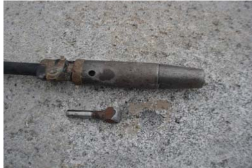
Figura 2.2: Bailarín o broca pequeña.
