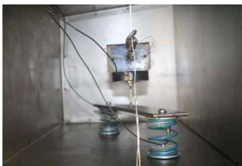
Figura 2. Configuración de la excitación creada dentro de la cavidad del motor del auto modelo, para CSM y MIM, en TPA Estructural.
